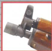
Die BWT 74 ist ein Gasdrucklader mit feststehendem Lauf und einem Drehkopfverschluss. Die Visierung besteht aus einem hoch sitzenden Korn mit seitlichen Schutzbacken und einer Klappkimme die bis 300 m eingestellt werden kann. Die BWT 74 ist eine robuste Waffe, deren Konstruktion ihre Zuverlässigkeit schon millionenfach unter Beweis gestellt hat. Auch bei der BWT 74 wird das Systemgehäuse aus dem vollen Material gefräst\*, was eine unvergleichliche Robustheit und Stabilität ermöglicht.
