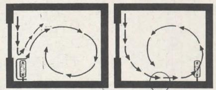
Die Raumluftströmung wird von Standort der Heizfläche bestimmt. Die Anordnung unter dem Fenster (1.) ist günstiger als die an der gegenüberliegenden Wand.
