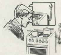
Wenn Ihr Gasgerät an einer (Gas-)Steckdose angeschlossen ist, achten Sie bitte darauf, daß der Schlauch nicht verdreht oder geknickt ist und nicht beschädigt wird! Sorgen Sie auch dafür, daß es ihm nicht zu heiß werden kann; er darf den Flammen und den heißen Abgasen des Backofens nicht zu nah kommen.
